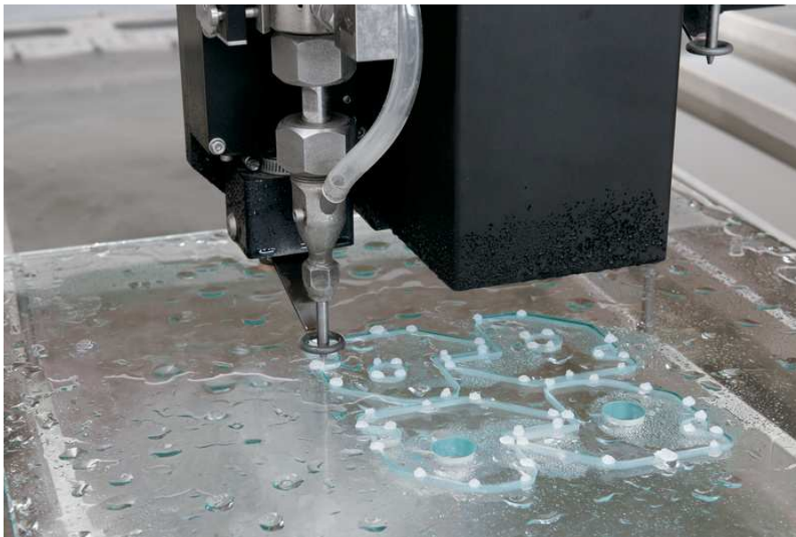
Der FixMaster schießt Leimpunkte in den Schnittspalt: Teile können während des Schneidprozesses nicht mehr ausbrechen oder in den Schneidstrahl rutschen.
