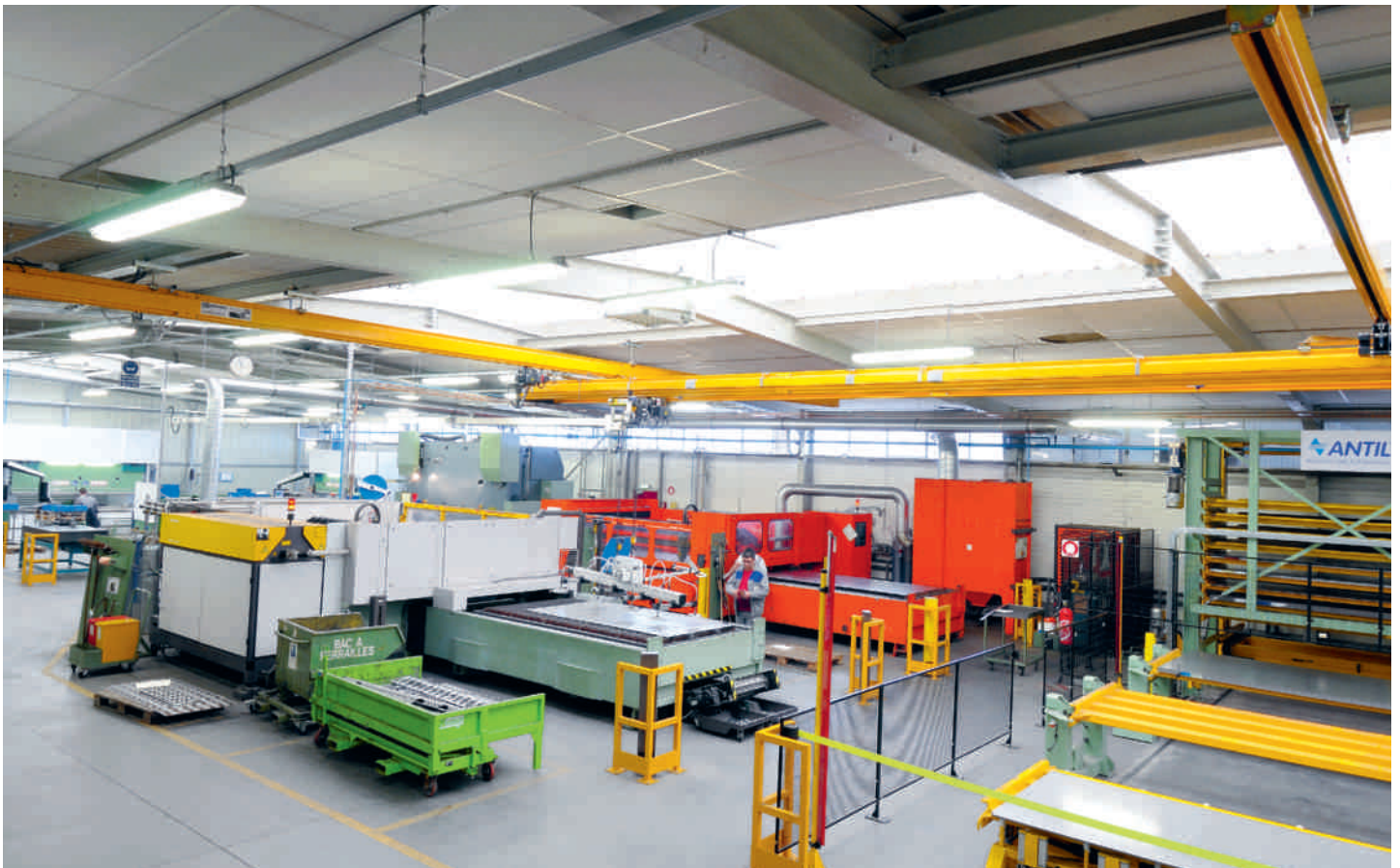
Der kundenspezifische Umbau von LKW ist für Mercedes-Benz ein wachsendes Geschäftsfeld, das einen hohen Bedarf an Laserteilen generiert. Insgesamt vier Laserschneidsysteme befinden sich in Molsheim im Einsatz, auch diese beiden Stand-alone-Maschinen der Bystar Produktserie.
