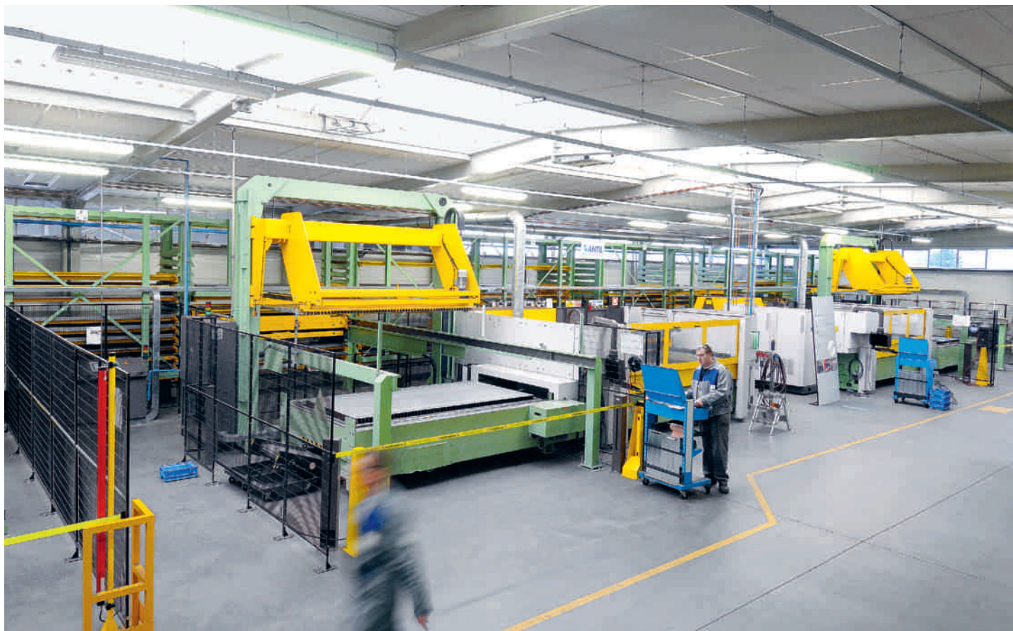
Bei der Teileproduktion von Mercedes-Benz Molsheim bestimmen Kleinserien und Einzelanfertigungen den Arbeitsalltag. Bystronic Laserschneidanlagen und ein vollautomatisches Antil Lagersystem sorgen für die notwendige Flexibilität und Schnelligkeit.
