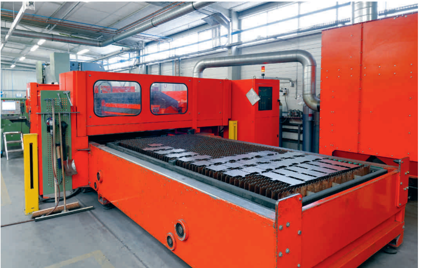
Auch die Bystar 3015 mit 3000 Watt Laserleistung aus dem Jahr 2000 ist voll in die Teilefertigung eingebunden.
